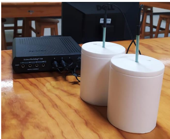
Figura 3. Sensores de temperatura colocados dentro de los calorímetros que contienen los líquidos.
