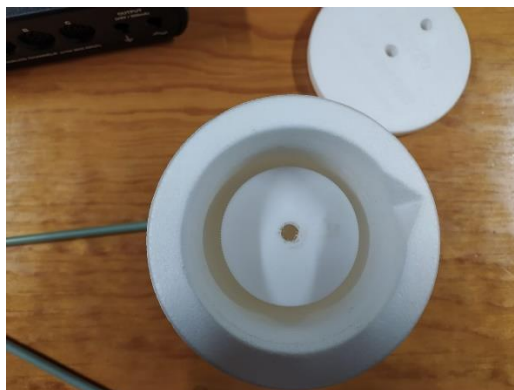
Figura 2. Recipiente cilíndrico pegado dentro del calorímetro.
