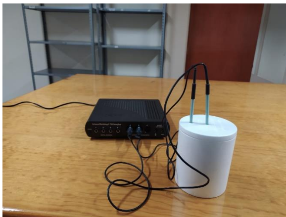
Figura 3. Sensores de temperatura colocados dentro de los recipientes.
