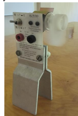
Figura 5: Capacitor Térmico (Efecto Seebeck modificado)
