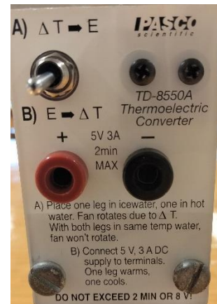
Figura 1: Interruptor en Convertidor Termoeléctrico
