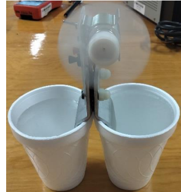
Figura 4: Configuración para efecto Seebeck
