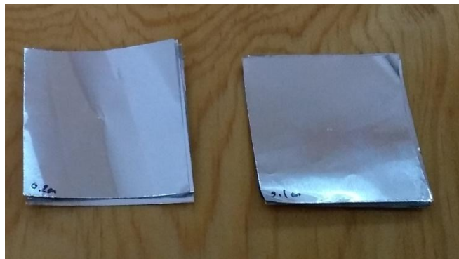
Figura 3. Láminas de aluminio de 2 mm y 1mm de distancia entre perforaciones.
