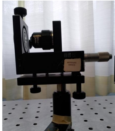
Figura 3. Filtro espacial montado.
