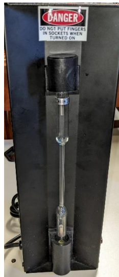
Figura 2. Forma en la que se coloca la lámpara en la fuente-montura.
