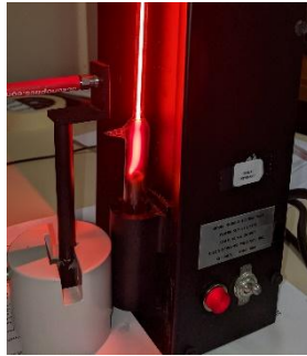
Figura 3. Alineación de la fibra óptica y la lámpara.
