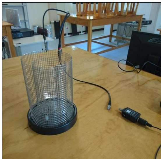
Figura 3. Muestra la conexión del cable con puntas caimán a la jaula y el otro extremo al sensor de carga.
