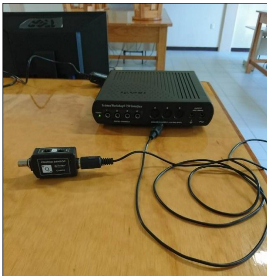
Figura 2. Se muestra la conexión del sensor de carga a un puerto de la interfaz.
