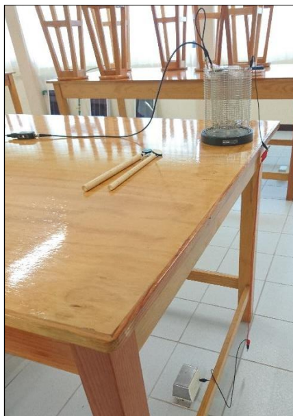
Figura 5. Muestra la conexión a tierra de la jaula de Faraday.
