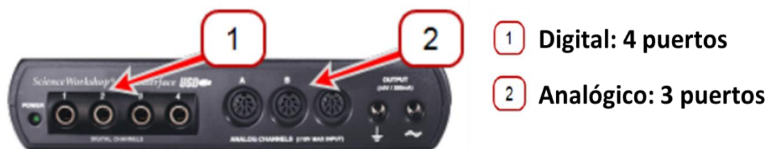
Figura 4. Puertos de la interfaz ScienceWorkshop 750 para conectar sensores digitales o analógico.
