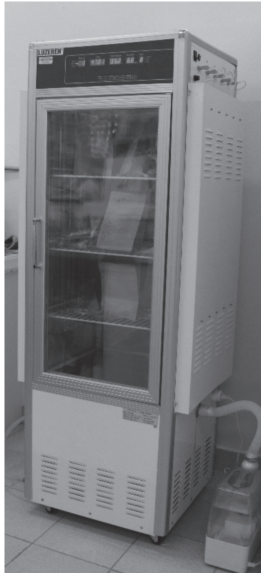
Fotografía 9. Cámara climática, marca Luzeren.
