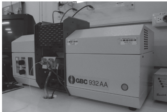
Fotografía 5. Espectrofotómetro de absorción atómica 932 AA.
