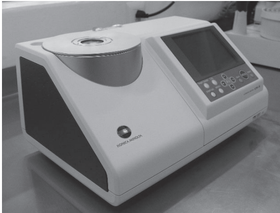
Fotografía 11. Colorímetro, marca Konica Minolta.
