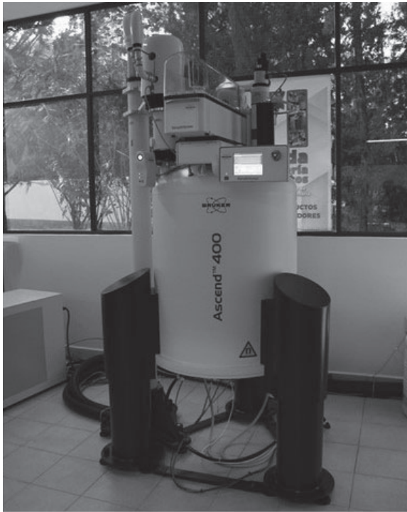
Fotografía 2. Espectrómetro de Resonancia Magnética Nuclear.
