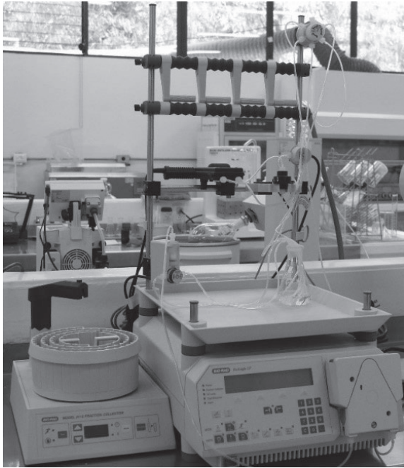
Fotografía 7. Sistema de purificación de proteínas BiologicLP.
