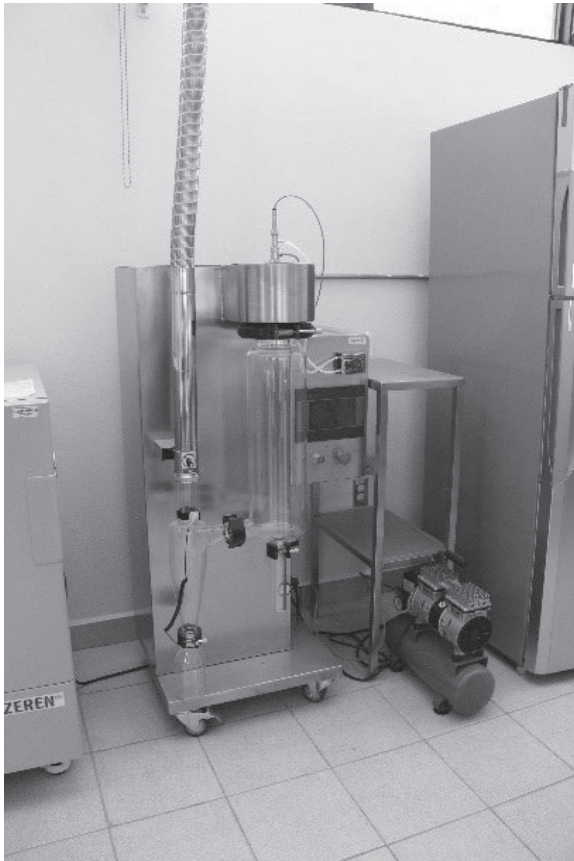
Fotografía 12. Secador por aspersion de 1.5 L/h.
