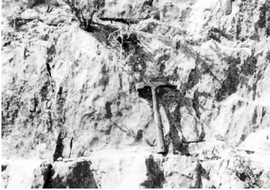
Fotografía No. 11.- Calizas marmorizadas de la Formación Teposcolula en el área La Raya, nótese ligero fracturamiento y estratos de mas de 80.00 cm, en la parte baja de la formación.
