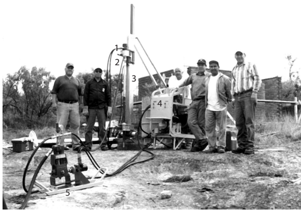
figura 3. Equipo de perforación Explorer Junior mostrando sus componentes más importantes: 1) unidad de perforación, 2) unidad de rotación, 3) panel de comando, 4) unidad de fuerza, 5) bomba de lodos.
