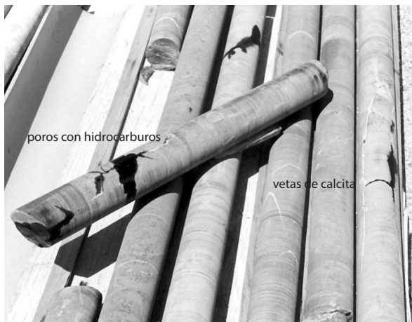
figura 5. Núcleos de calizas de la Formación Morelos mostrando vetas de calcita, poros y presencia de hidrocarburos.
