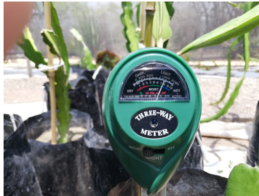
Figura 2.6: Midiendo la humedad adentro del vivero de la UTM.
